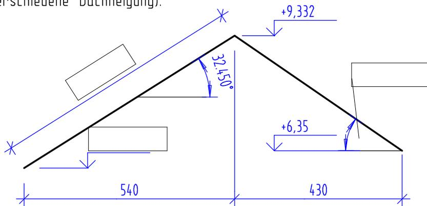
Berechne alle 3 Obholzgrößen, die Höhe der Fußpfette im Bezug zur Saumhöhe und den Sparrenüberstand beim Firstblatt (gleiche Dachneigung). Dachneigung 30,5°; Sparrenhöhe 16cm; Pfette 16/20
