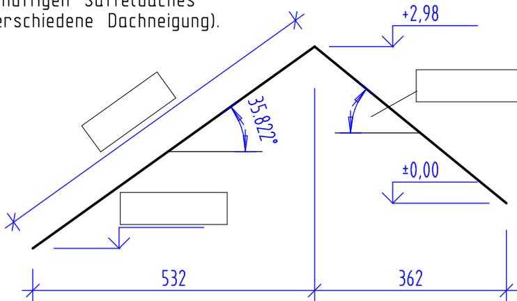
Sparrenteilung mit Giebelwände (Fixpunkte, Sparren sitzen an der Außenseite der Giebelwand).
