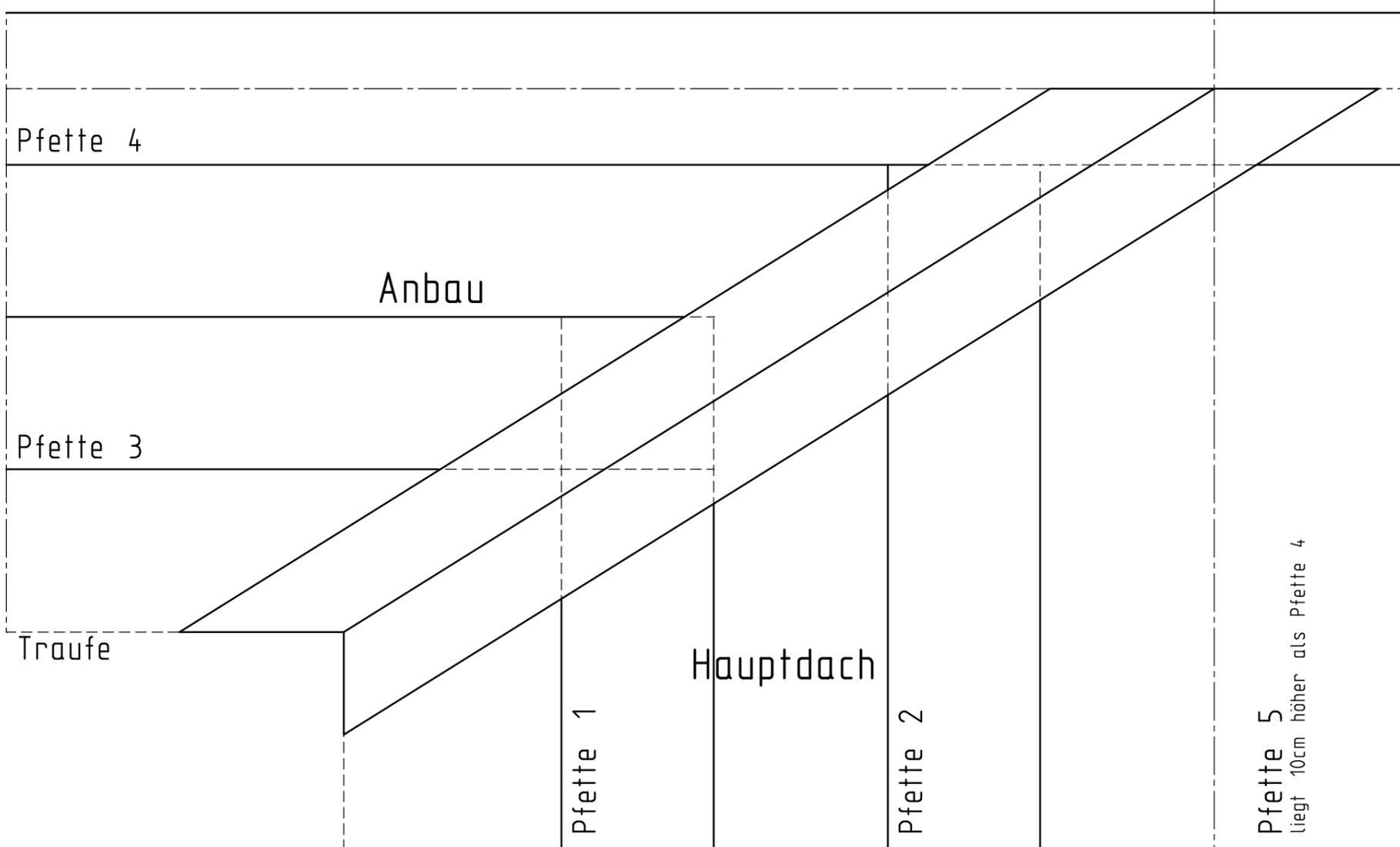
Kehlsparren mit ungleicher Dachneigung M 1:5
