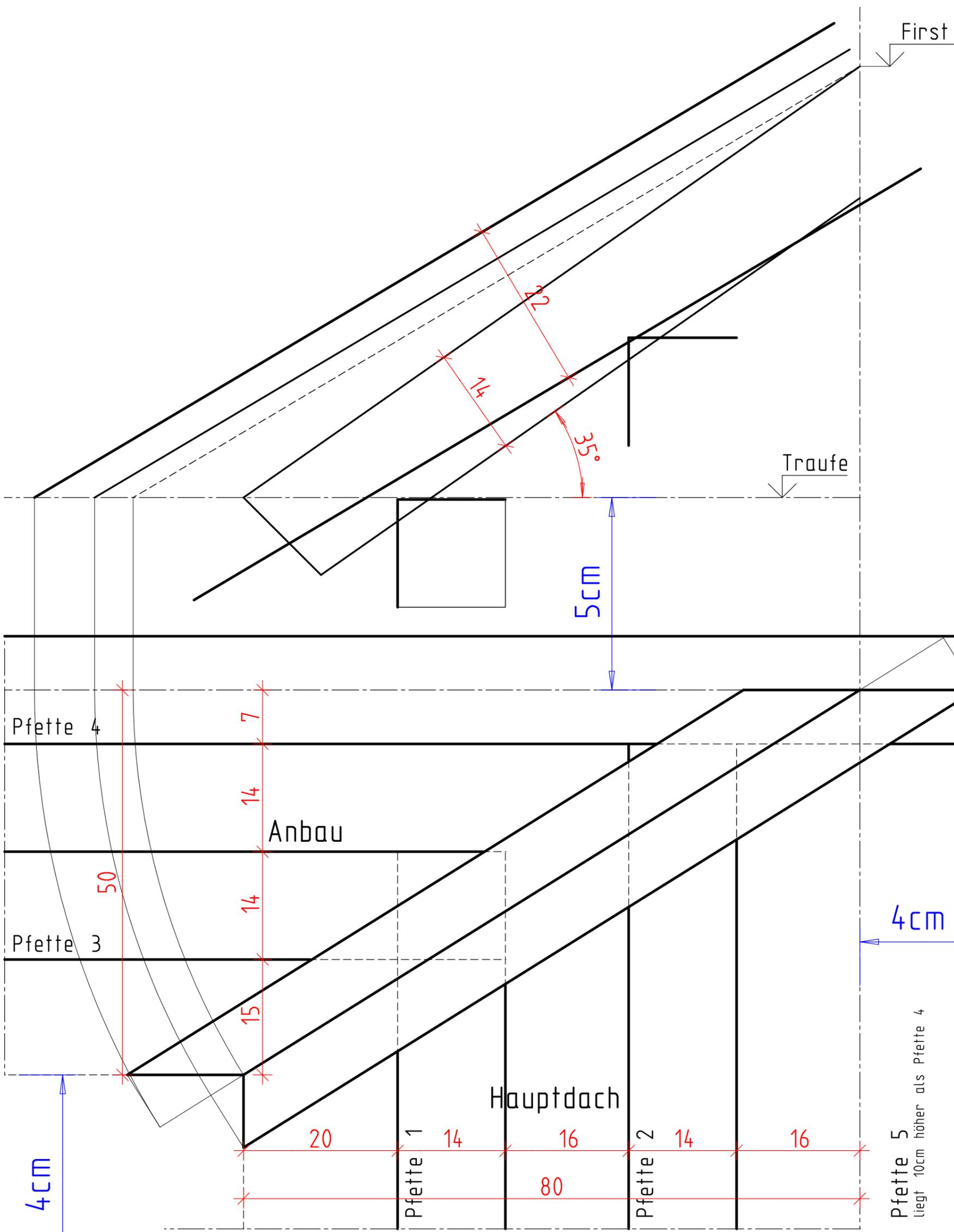
Kehlsparren mit ungleicher Dachneigung M 1:5
