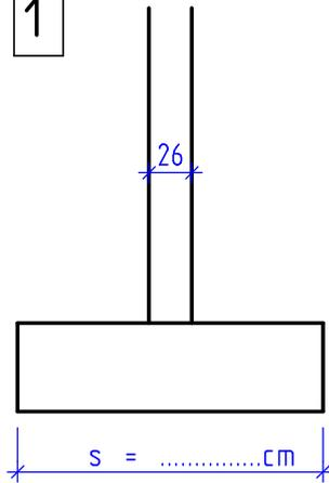
Stütze 20/26cm mit quadratischen Einzelfundament.
