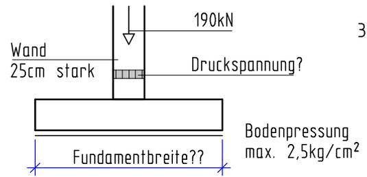
**23** Spannungen und Fundamentabmessung: 3P
